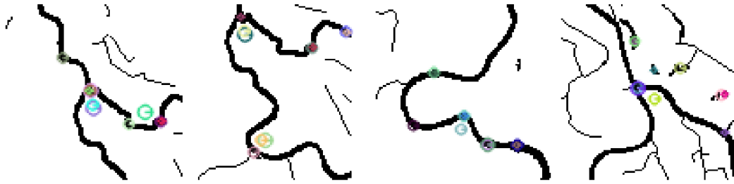
Abbildung 4.3: Die farbigen Kreise stellen die markanten Punkte dar, die mit dem KAZE-Detektor in beispielhaften Kartenausschnitten gefunden wurden. Die unterschiedliche Größe der Kreise kennzeichnet die Skalierung des Interessenspunktes. Man erkennt, dass die Punkte vor allem an Kreuzungen und starken Biegungen der Signaturen liegen. Für die bessere Lesbarkeit wurden die Ausschnitte der Segmentierung invertiert: schwarz sind die Signaturpixel, weiß der Hintergrund.
