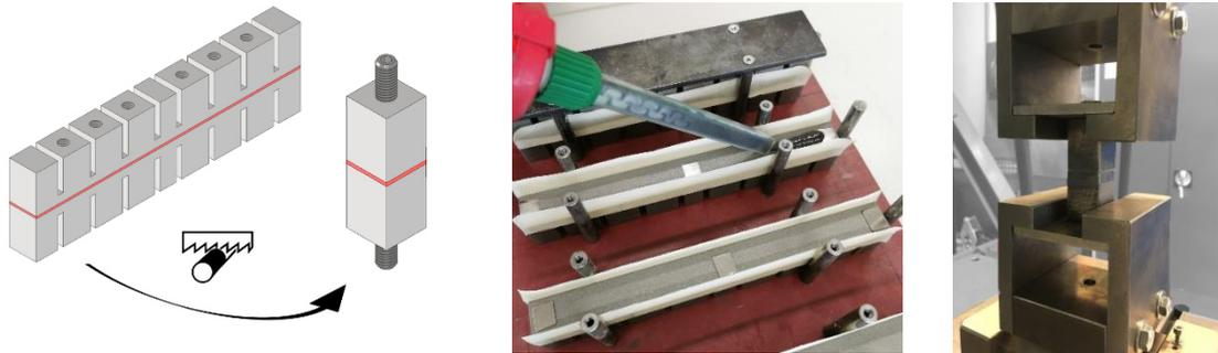
**Bild 5.24:** Herstellung und Versuchsanordnung der stumpf geklebten Prüfkörper
