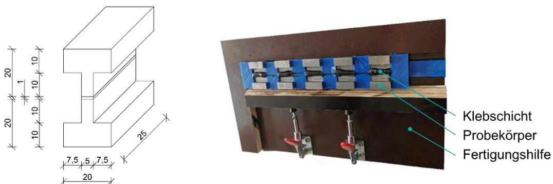
**Bild 5.49:** Weiterentwicklung des Probekörpers (links) Fertigungshilfe (rechts)
