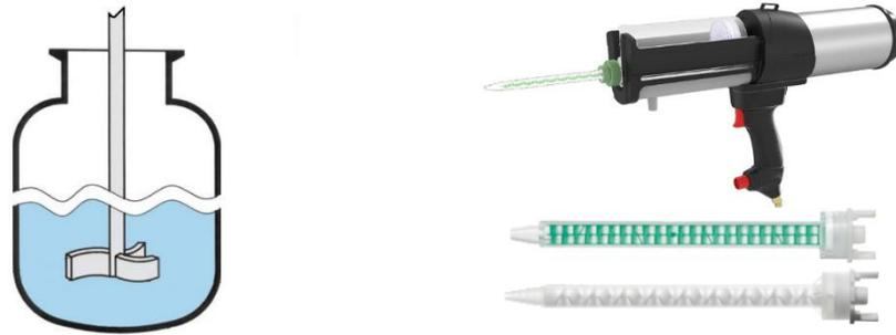
**Bild 5.9:** Dynamische Mischung (links) und statische Mischung (rechts)
