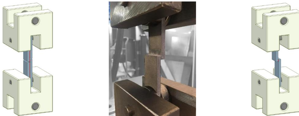
**Bild 5.37:** Zugscherprobe nach DIN EN 14869-2 (links) und Zugscherprobe nach alternativer Herstellung (mitte und rechts)
