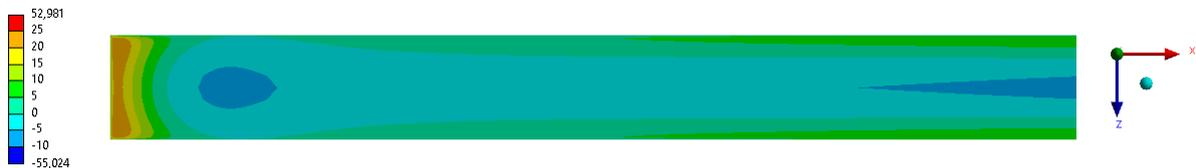
**Bild 6.7:** Normalspannungen  $\sigma_y$  [N/mm<sup>2</sup>] in der Klebschicht zwischen Steife und Platte im Horizontalschnitt auf halber Klebschichtdicke unter variabler Beanspruchung
