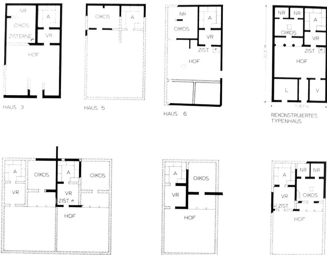
Abb. 3: Einige Grundrissbeispiele der Typenhäuser
