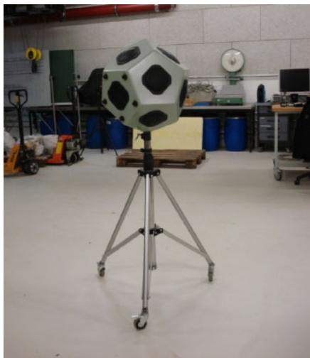
**Abbildung 29: Dodekaederförmiger Lautsprecher**
