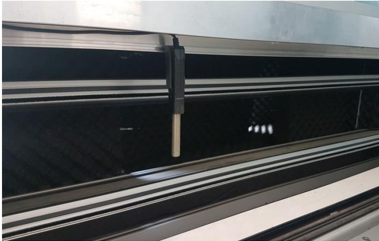
**Abbildung 13: Akustiksensordirekt hinter dem unteren Bypass**
