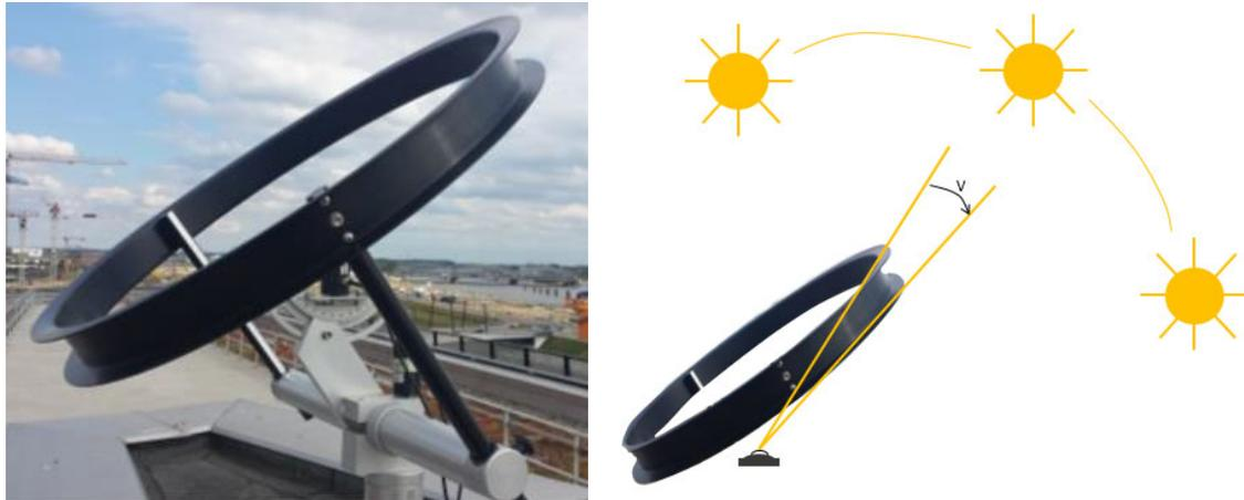
Abbildung 15: Verschatteter Strahlungssensor zur Messung der Diffusstrahlung
