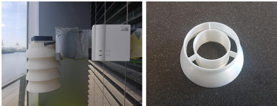
**Abbildung 11: Lufttemperaturfühler im Fassadenzwischenraum mit Strahlungsschutz**
