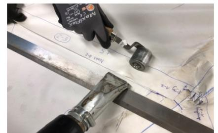
6-35 Handwerkliche Fertigung einer Flächennaht mit dem Warmgasschweißverfahren
