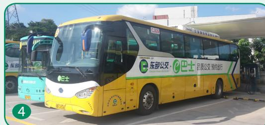
Abb. 3.09: (1) Paketdienstfahrzeug T3 von BYD, (2) BYD-Gütertransporter (< 3t), (3) BYD-Stadtreinigungsfahrzeug, (4) Elektrischer Pendler- und Fernbus der Shenzhen Eastern Bus Group
