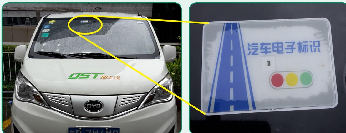
Abb. 3.21: Elektronische Fahrzeugsplakette (car electric sign) an einem E-Logistikfahrzeug in Shenzhen
