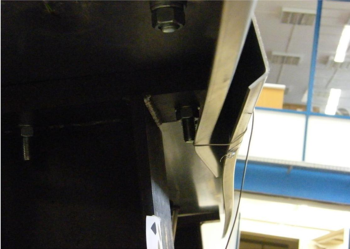
Bild A.7 Deformation der Unterurte im Bereich der Koppelstelle (von unten betrachtet); Versuch-Nr. 2.1 (Z300-25 + Z300-30)
