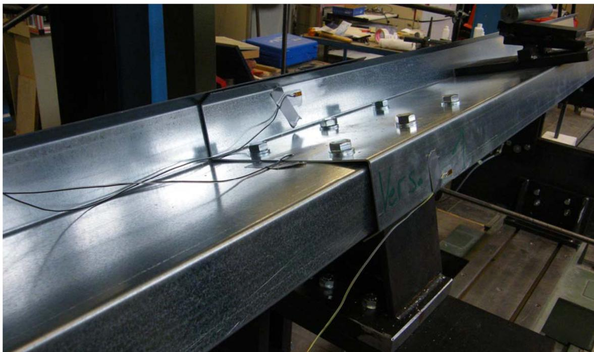
Bild 1.2 Koppelstelle eines Trägers im Prüfstand [50]
