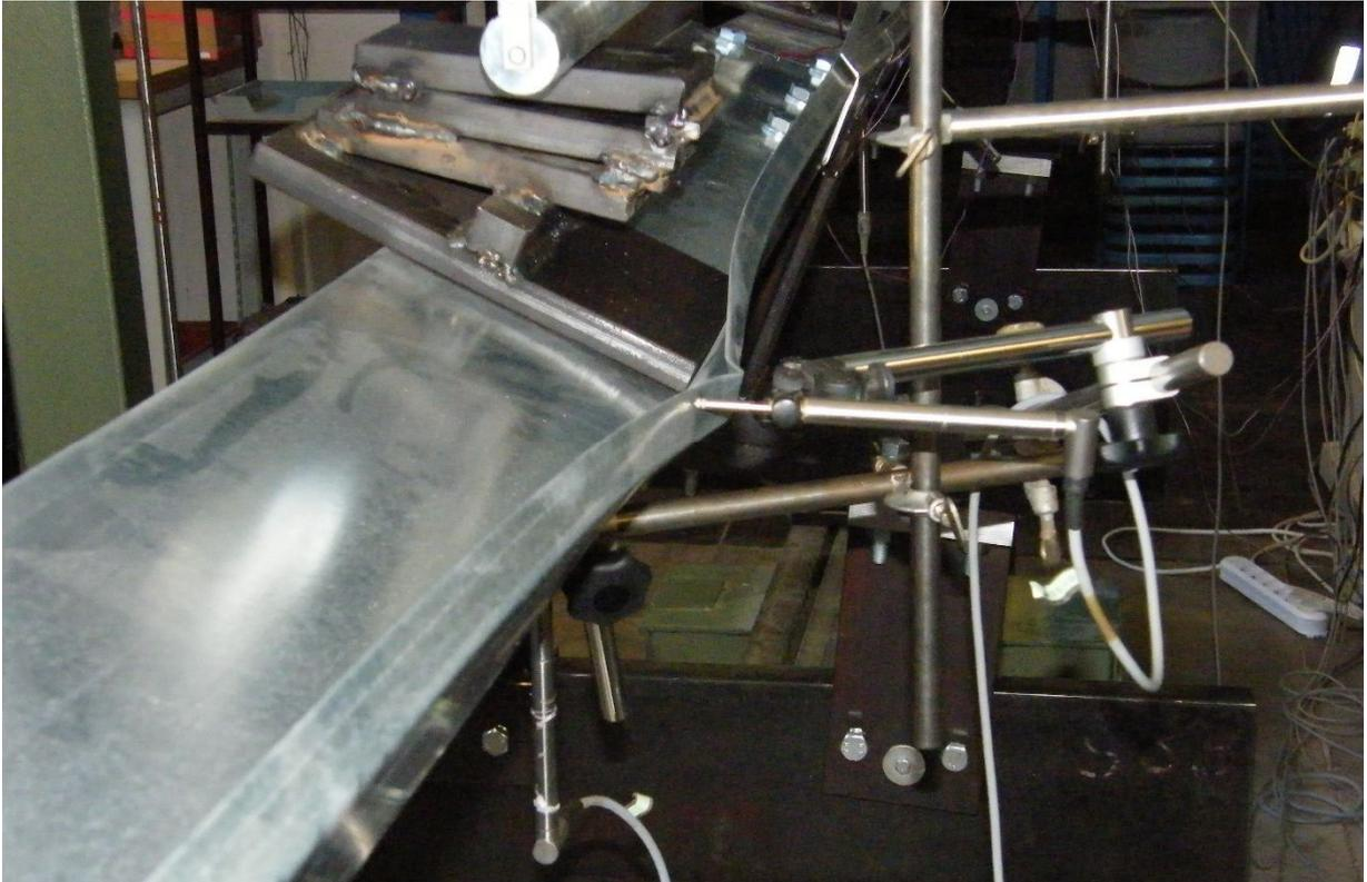
Bild A.5 Beulen des Obergurts in Feld 2; Versuch-Nr. 7.3 (Z180-20 + Z180-20)
