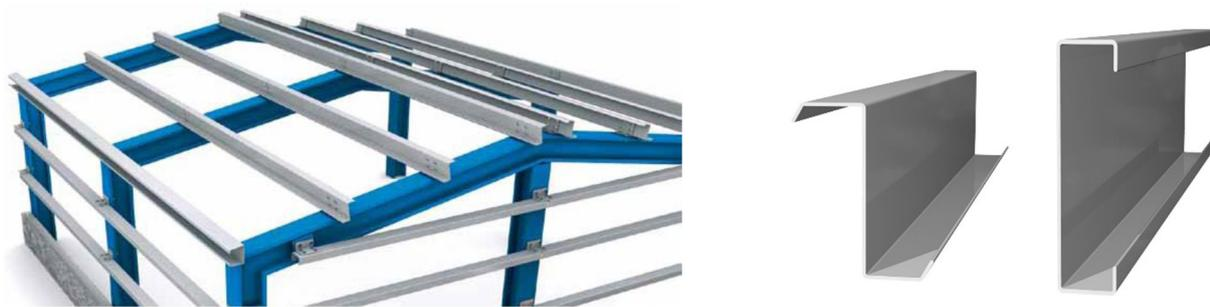
Bild 1.1 Einsatz von Z- und C-förmigen Kantprofilen im Industrie- und Hallenbau aus [82]
