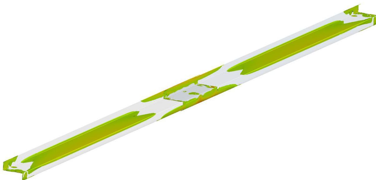
Bild C.16 Ergebnisse der numerischen Untersuchungen - Parameterreihe 3a, Streckentorsionsmoment, Stützweite  $L=3,50\text{m}$ : Qualitative Darstellung der Zugspannungsbereiche (Wölbormalspannung  $\sigma_\omega$ , Grenzlastniveau, elastisch)
