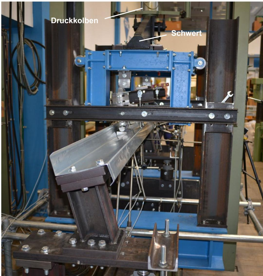
Bild 7.2 Versuchsaufbau Torsion - Seitenansicht
