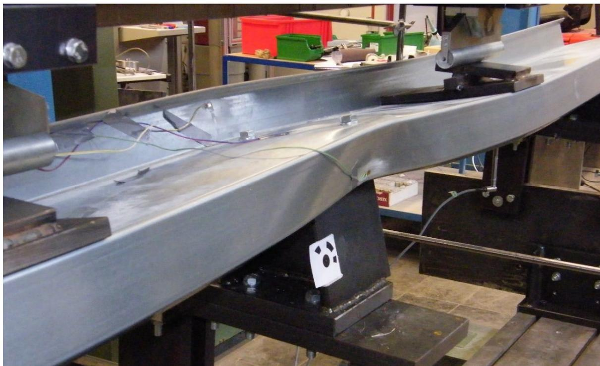
Bild 4.8 Beulen des Untergurts im Bereich des Zwischenauflagers;
