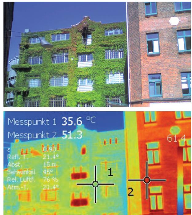
Abb. 7.4: Das Thermalbild zeigt den Unterschied der Oberflächentemperaturen einer Fassadenbegrünung im Vergleich zu einem Ziegelmauerwerk in Hamburg. Der Unterschied beträgt 15,7 Grad.
