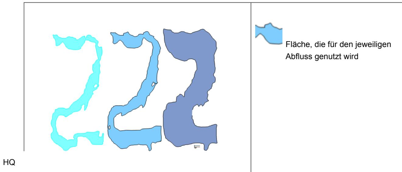
Abbildung 19 - Abgeleitete Breiten des Abflussprofils bei unterschiedlichen Abflüssen in der Kremper Au, Links - NQ, Niedrigwasserspiegel, Mitte - MQ, Mittelwasserspiegel, Rechts - HQ, Hochwasserspiegel, eigene Darstellung
