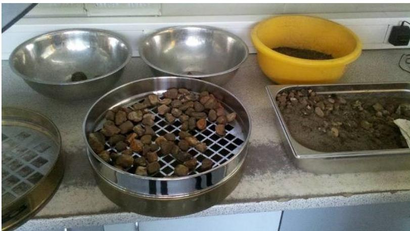
Abbildung 107 - Separierung einer Substratprobe im Labor, hier Darstellung der gesiebten Probe, September 2012, Foto S. Eggers (L+W)
