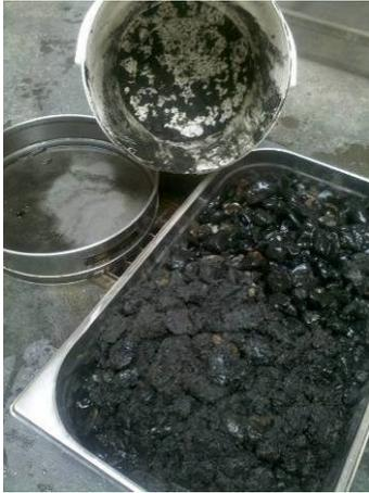
Abbildung 106 - Substratprobe im Labor, hier Darstellung der ungewaschenen und ungesiebten Probe, September 2012, Foto S. Eggers (L+W)
