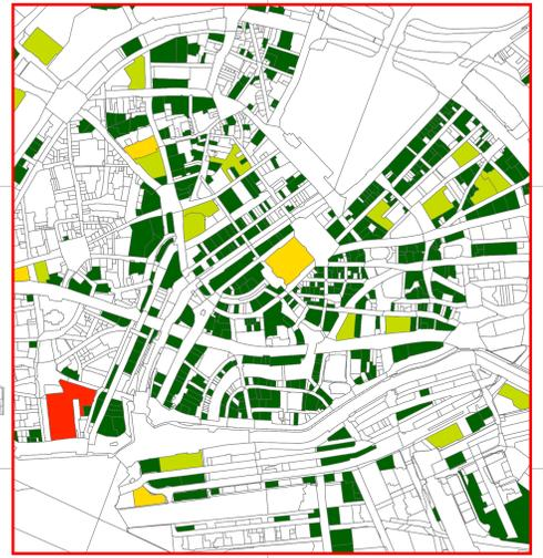
Übersicht über das theoretische Lastverlagerungspotenzial für Bürogebäude und Gebäude büroähnlicher Nutzung aus Kälteanlagen für Klimatisierung in Hamburg
