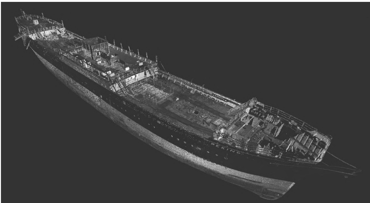
Abbildung 4.3: Punktwolke der „Peking“ aus Laserscans erzeugt
