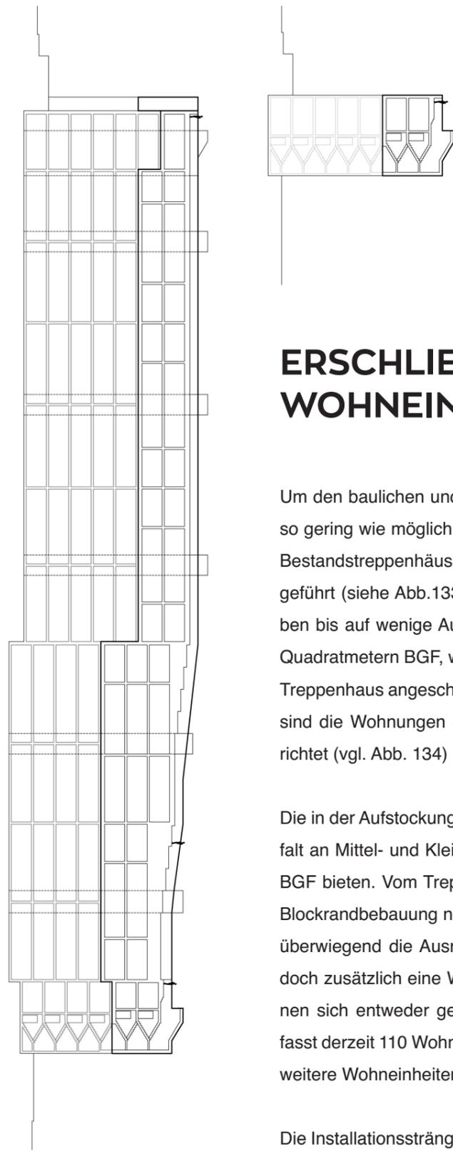
**Abb. 133** Längs- und Querschnitt durch die Blockrandbebauung mit Aufstockung
