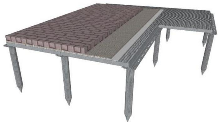
Abb. 7: Wurzelbrücke
