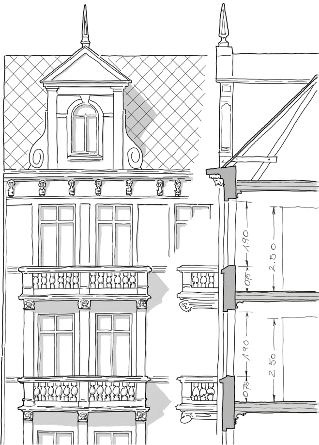
Abb. 1.1: Systemskizze eines gründerzeitlichen Gebäudes in Hamburg
