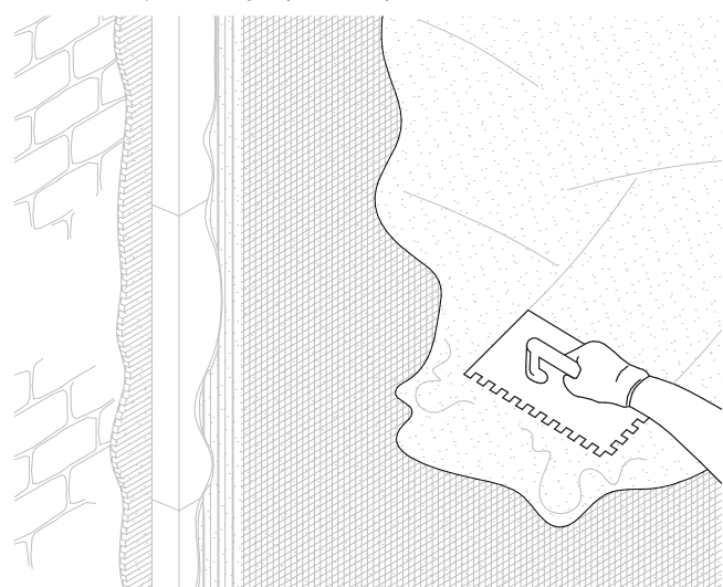
11. Kalkzementputz auftragen (Glättkelle)
