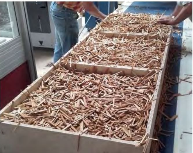
Abb. 13.16: Herstellung Typha-board - Rohrkolben in einer Spanplattenanlage
