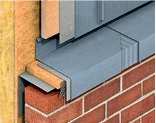
Abb. 8.16 Ausführung Gesimsabdeckung im Neubau (Firma Rheinzink)
