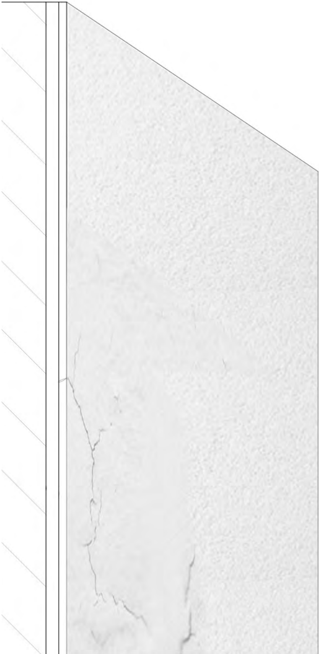
Schadensbild A : Putzbedingter Riss z.B. Schwindriss
