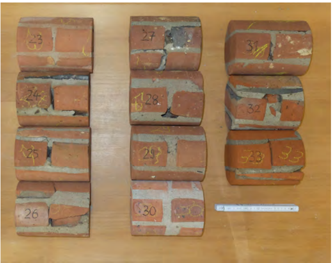
Abb. 5.16: Bohrkern von Ziegelmauerwerken
