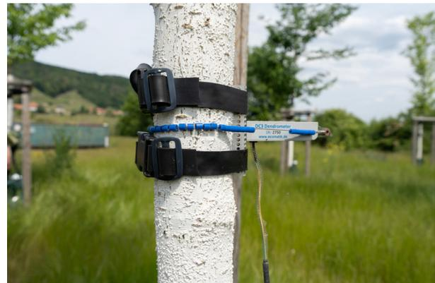
Abb.: 56 Baumrigolen in der Versuchsanlage Pillnitz (links) und Detailaufnahme eines Dendrometers (rechts) (Kirya Heinemann, HCU).
